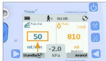
7. Vérifier si la valeur de la fuite aérienne est plausible
