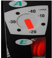
• Vérifier que l'accordéon rouge soit élargi jusqu'à la marque (triangle blanc) permettant de vérifier le fonctionnement de l'aspiration.
